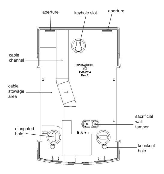
Figure 18. Galaxy Mk7 Keypad Backplate Installation
