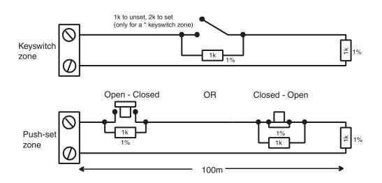
Figure 9. Keyswitch/Push-Set Zone wiring
